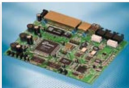
音声処理チップセット「VINETIC」とホームゲートウェイコントローラを組み合わせたATAシステムソリューション
