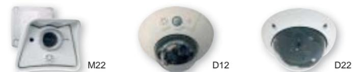
「M22」は、屋内/屋外仕様の単眼カメラでVoIP機能も内蔵。2眼屋内ドームカメラ「D12」は、赤外線パッシブセンサーを装備するほか、画角90度の超広角レンズを2つ組み合わせることで180度のパノラマ表示が可能。「D22」は高強度ドームやステンレス製スチールリングを用いた「耐破壊行為セット」などのオプションを用意している。レンズの交換も可能で、カラー/白黒、および画角により選択できる。2眼タイプは自由な組み合わせが可能
