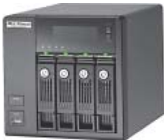
「TV会議録画Station」のHDD容量は6TB (RAID5)と、民生用のHDDレコーダーと比べて大容量なのも特徴だ。録画と再生はネットワーク上のPCのブラウザから操作できる
