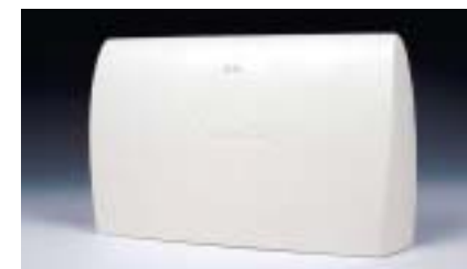
各部屋に設置する「CPS200」。電話、テレビ、インターネットアクセスに対応したRJ45のポートを用意しており、QoS確保にも対応
