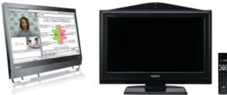
持ち運べる一体型端末の例。左は、ブイキューブのWeb会議「V-CUBEミーティング」をタッチパネル型PCにプリインストールした「V-CUBE センター」(2010年12月発売)。カメラ内蔵で、マイクはUSBで接続する。電源を入れるだけですぐにWeb会議ができる。右は、ソニーの「PCS-XL55」(2011年1月発売)。21.6型モニターにカメラ・マイクを内蔵している
