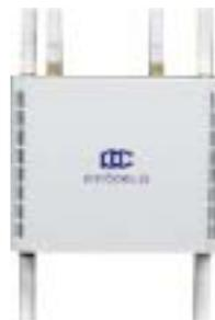
PicoCELAの無線LANアクセスポイント「PCWL-0100」は142×118×39mm、450gという小型軽量を実現している。見通し内中継回線到達距離は約150m
